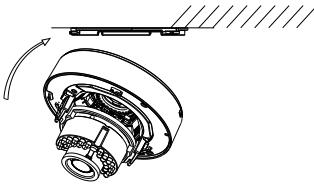
Рисунок 2-3 Крепление камеры к потолку
