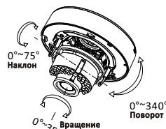
Рисунок 2-4 3-х осевая установка
