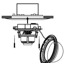
Рисунок 2-8 Установка камеры на монтажную коробку
